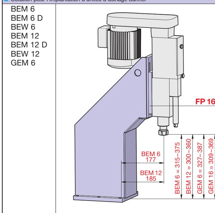
● Abmessungen für den Aufbau von Suhner-Bearbeitungseinheiten
