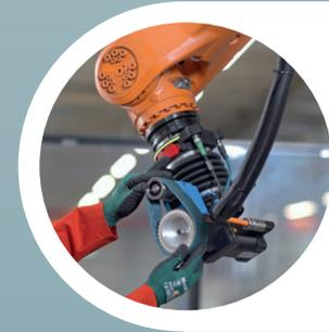
**Smerigliatura, lucidatura robotizzata di Suhner: trattamento delle superfici robotizzato.**
