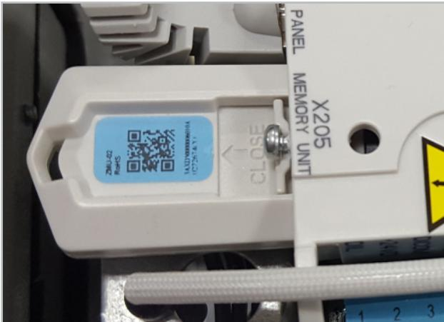
Die Steuerungsparameter und -programme sind auf einem Speicherbaustein, der Bestandteil der Steuerung ist, gespeichert.
