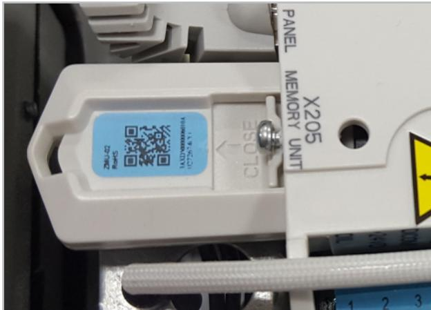
I parametri e i programmi di comando sono memorizzati su un componente della memoria, che è parte del comando.
