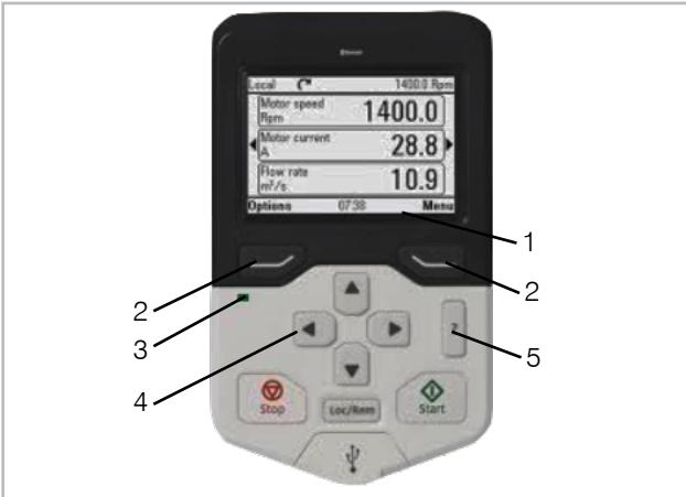
Navigationszeile: Zeigt die aktuelle Funktion der Tasten (2) und die Uhrzeit an (1). Menueführungstasten (2). Statusleuchten: grün = keine Störung, rot = Störung (3). Scrollen in Menue oder Liste; erhöhen oder verringern eines Parameterwertes (4). ?-Taste um mehr Informationen bei Parametern zu erhalten (5).
