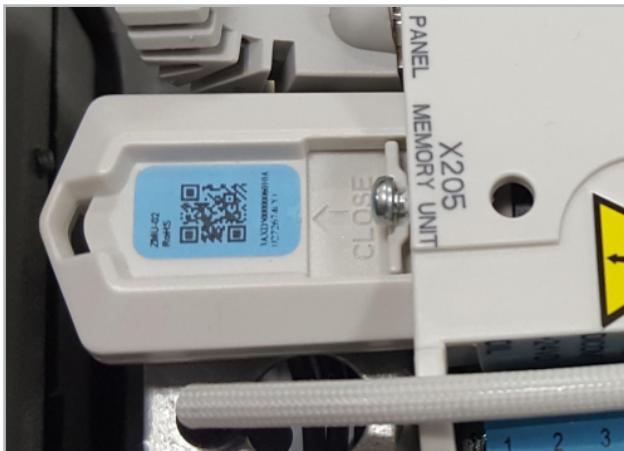
Les paramètres et programmes de commande sont sauvegardés sur un module de mémoire qui fait partie de la commande.
